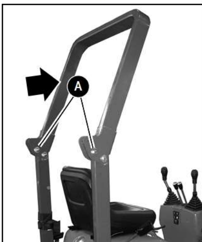
Fig. 85: Subir la barra antivuelco
