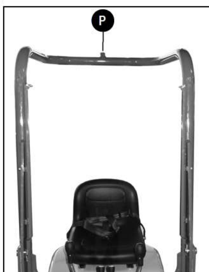
Fig. 91: Soporte para luz giratoria
