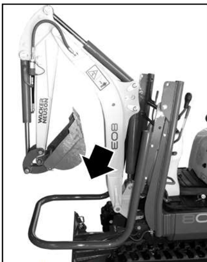
Fig. 88: Barra antivuelco bajada
