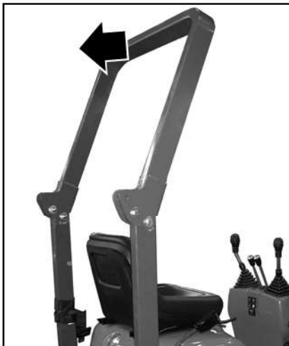
Fig. 84: Bajar la barra antivuelco
