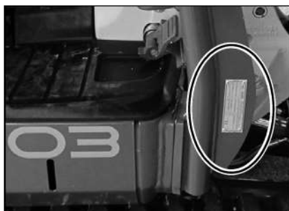
Fig. 2: Placa de características barra ROPS (representación simbólica)
