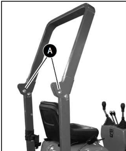
Fig. 83: Bajar la barra antivuelco
