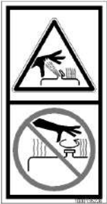
Fig. 26: Depósito bajo presión
